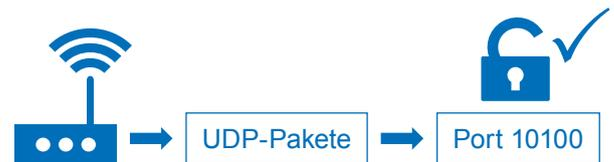
Im Normalbetrieb meldet sich jedes Schlüsseldepot einmal pro Minute am Webserver an. Jedes Schlüsseldepot hat einen eigenen Key mit dem die Telegramme verschlüsselt werden.
